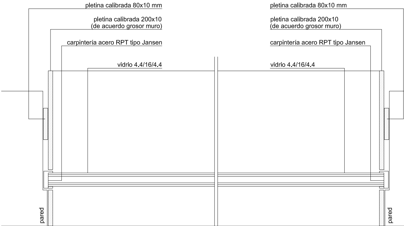
DETALLE HORIZONTAL VENTANAS SILO E14.1/E14.2. e: 1/5
